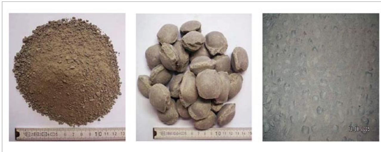
Abb. 2: Bentonitmaterialien a.) Bentonitgranulat 0–3 mm, b.) Bentonitpresslinge, c.) binäres Gemisch im Einbauzustand / Bentonite materials
