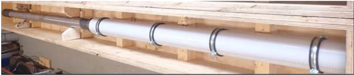
Abb. 17: Bentoniträger mit Anschlussstange (innen mit Memoryspeicher) im Zusammenbauzustand, das Bentonitelement ist für den Transport durch fixierte KG-Rohrhälften geschützt.
